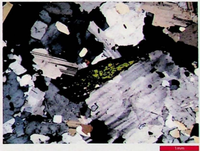
Foto 10: Idem a Foto 7, polarizadores cruzados. Notar o contato reto entre o piroxênio e a hornblenda e a matriz quartzo-feldspática (SAL-01).
