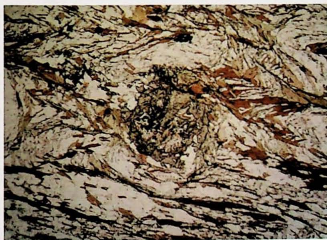
Foto 16: Porfiroblasto de granada rotacionado (sentido anti-horário) envolvido pela foliação definida por cristais de biotita e muscovita. Observar o cristal de estaurolita na porção superior do porfiroblasto. Polarizadores descruzados (ENC-06).
