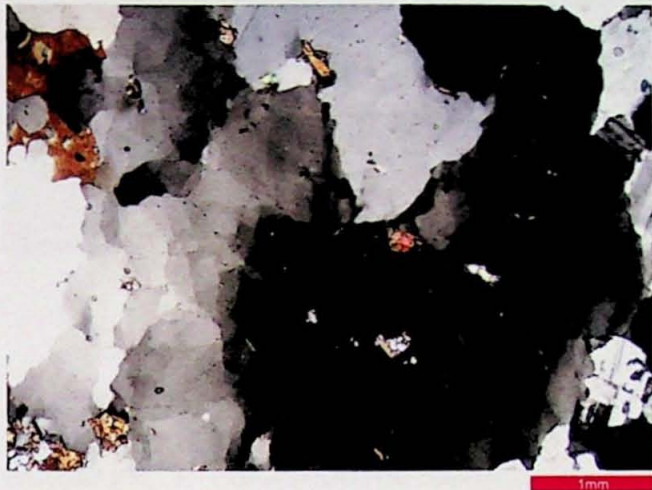
Foto 7: Cristais de quartzo com extinção ondulante. Notar que não há recristalização. Polarizadores cruzados (SAL-02).
