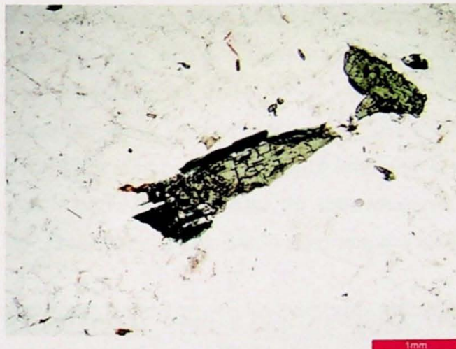
Foto 9: Cristais de augita com hornblenda associada. Polarizadores descruzados. Porção central do plúton (SAL-01).
